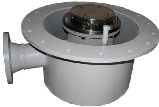
Esta válvula cuenta con un sistema que deja ingresar el agua pluvial pero bloquea el orificio de conexión al ambiente, cuando se rompe un sello o una cañería del drenaje.
